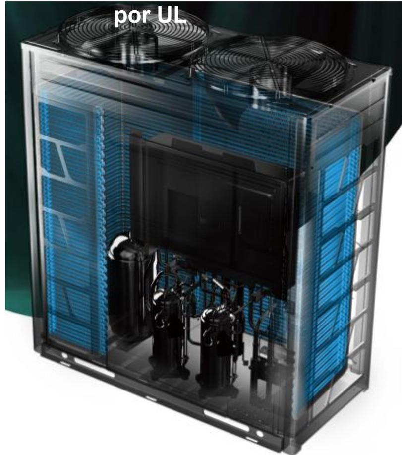
Las aletas anticorrosivas de Hisense están recubiertas con resina epóxica mediante técnicas de formación de películas, mientras que las resinas tradicionales son acrílicas. La resina epóxica es 1.5 veces más gruesa que la resina acrílica, y sus propiedades resistentes a los ácidos, a los álcalis y a la niebla salina son 3 veces mejores que las de la resina acrílica.
